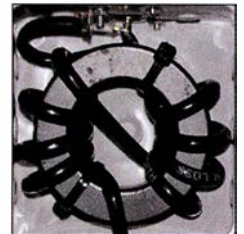
Bild 4: Strombalun mit zweimal 4 Wdg. Aircell5 auf einem FT240-43 Fotos: DK7ZB
