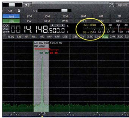
Bild 5: Beispiel für die Pegelanzeige des Colibri-Nano, hier ein -60-dBm-Signal im 20-m-Band
