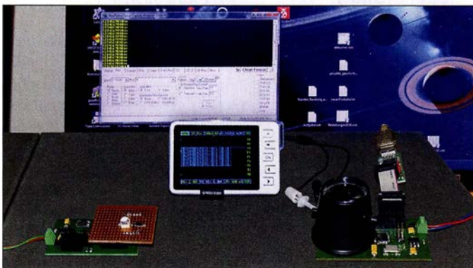
Bild 1: Bei diesem Versuchsaufbau wird das von einem Modul abgestrahlte Signal an der Decke reflektiert, über eine Linse auf der Fotodiode des zweiten Moduls konzentriert und anschließend auf Mini-oszilloskop und Terminalprogramm angezeigt.
