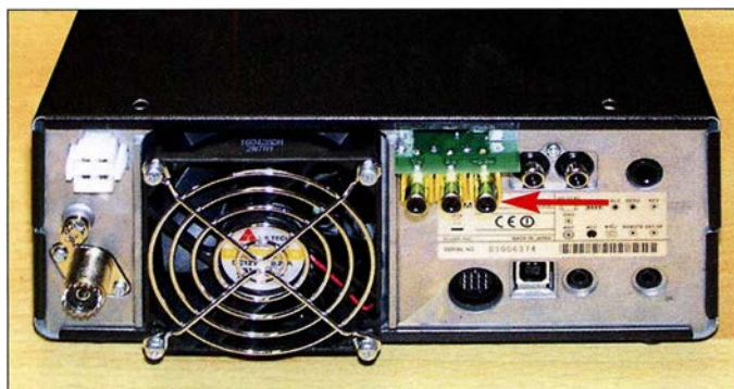
Bild 1: Rückseite des IC-7300 mit den zusätzlichen drei Anschlussbuchsen des Transverter-Interface (Pfeil)
