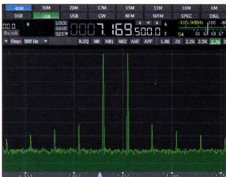
Bild 11: Intermodulationsprodukte eines Zweitonsingals ohne Dithering
