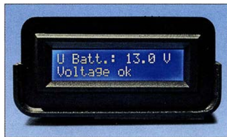
Bild 7: Ausgabe von aktueller Akkumulatortension und Betriebszustand
