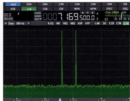
Bild 12: IM-Produkte nach dem Einspeisen eines starken Signals ( Dithering )
