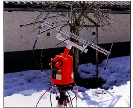
Bild 5: Portabelrotor im praktischen Einsatz; hier ist er auf ein Stativ montiert und bewegt die angebaute Antenne.
