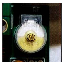
Bild 3: Ein voll ausgedrehter Trimmerkondensator C1 erfordert das Entfernen von fünf Windungen der Sekundärwicklung des Bandpassfilters.
