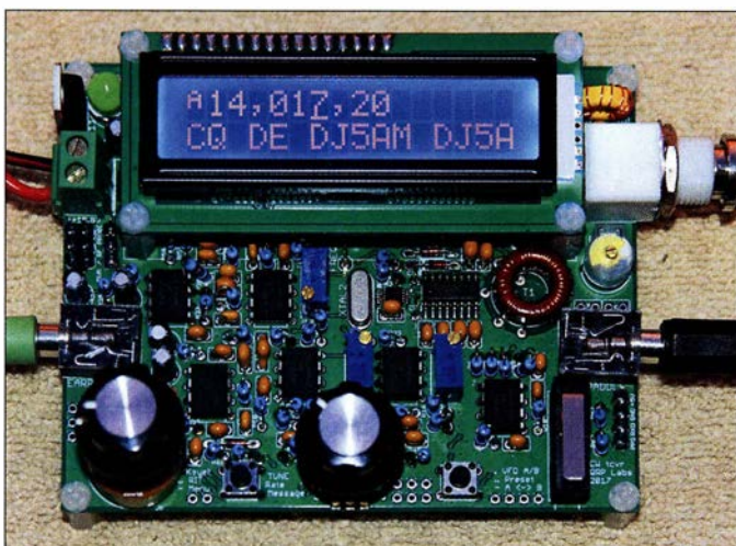
Bild 1: Komplett aufgebauter Transceiver QCX, hier die 20-m-Version, mit eingeschaltetem CW-Decoder Foto: DJ5AM
