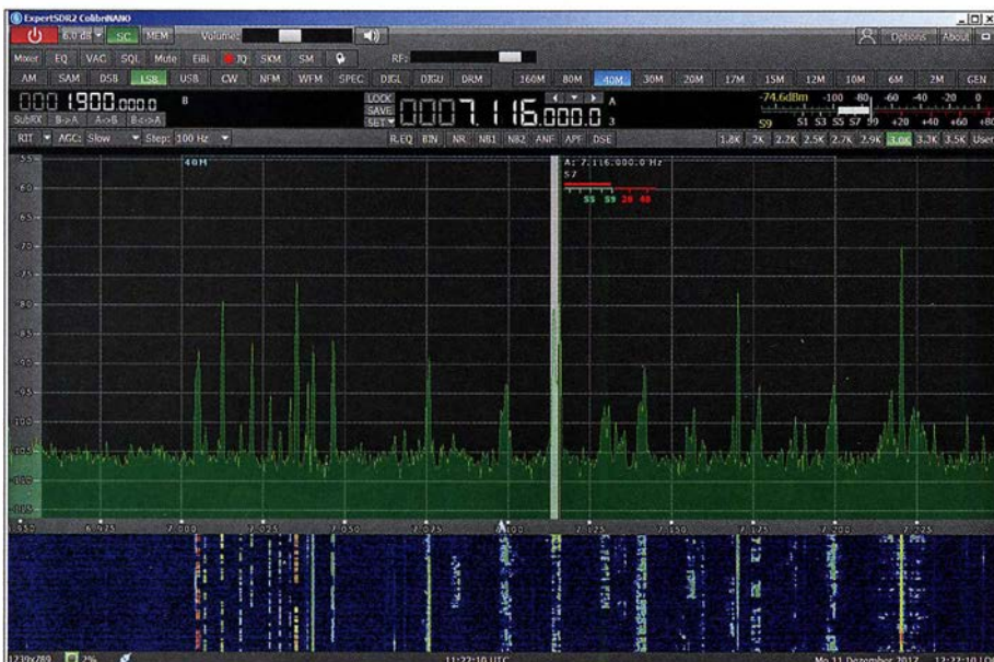
Bild 2: Bedien- und Anzeigekonzole der Steuersoftware ExpertSDR2 für den Colibri-Nano; hier beim Empfang im 40-m-Band
