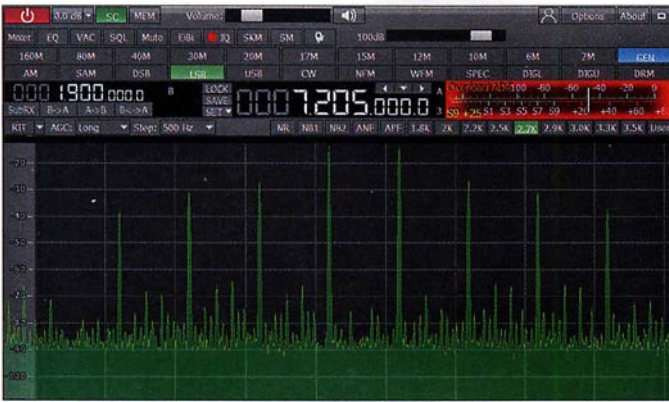
Bild 8: Starke Verzerrungen durch Begrenzung des ADU und Anzeige Overload ADC
