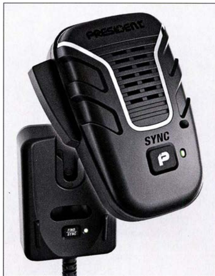
Das von President entwickelte drahtlose Lautsprechermikrofon Liberty lässt sich dank der sechspoligen Mikrofonbuchse am Bill verwenden.
