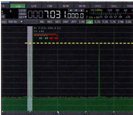
Bild 9: Zwei eingespeiste Nutzsingale im 40-m-Band...
